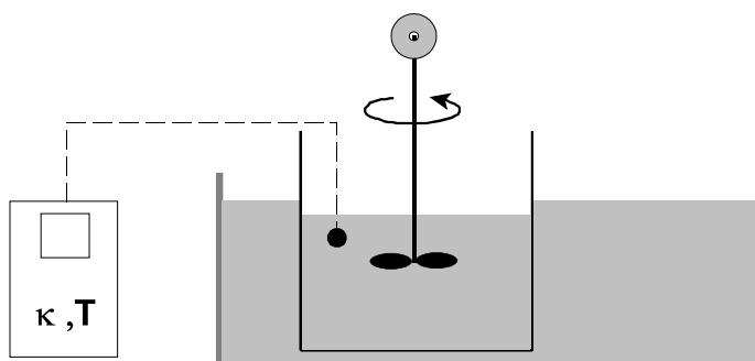
Como material auxiliar para medir las concentraciones en función del tiempo se dispone de un conductímetro y un cronómetro, así como del material necesario para la preparación de las disoluciones de los reactivos (probetas, pipetas, matraces aforados, balanza). Se trabajará con un volumen de reacción de **500 ml**, a una concentración inicial de cada uno de los reactivos de **0,05 mol/l**.
