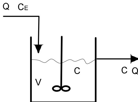
Obsérvese que, al ser constante el volumen del tanque, el caudal de salida será idéntico al de entrada y al estar su contenido perfectamente mezclado, la concentración de la corriente de salida será idéntica a la del interior del tanque.
