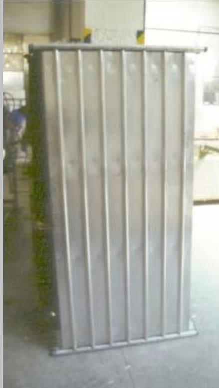
Placa captadora de un panel solar
