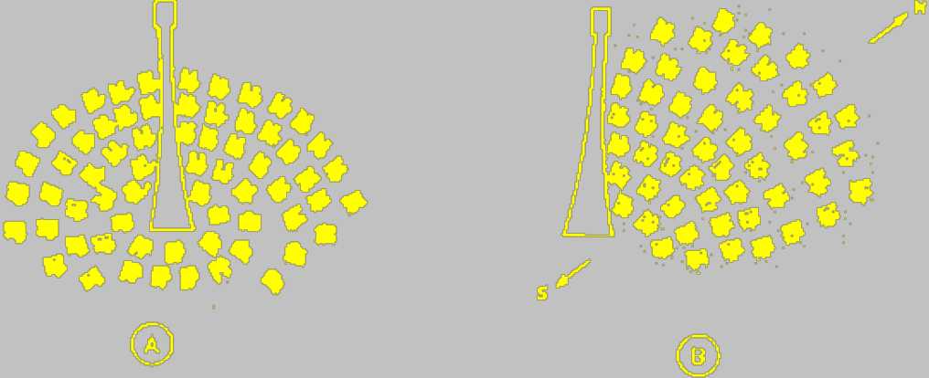
FIGURA 2.7: Centrales solares de torre: a) Torre central b) Campo Norte
