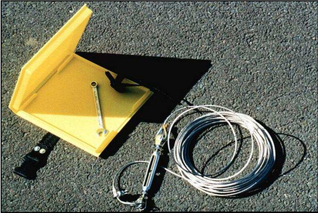
Cable de sujeción de la estructura
